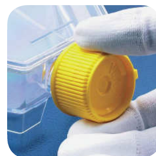
Posição para vedar ventilação
