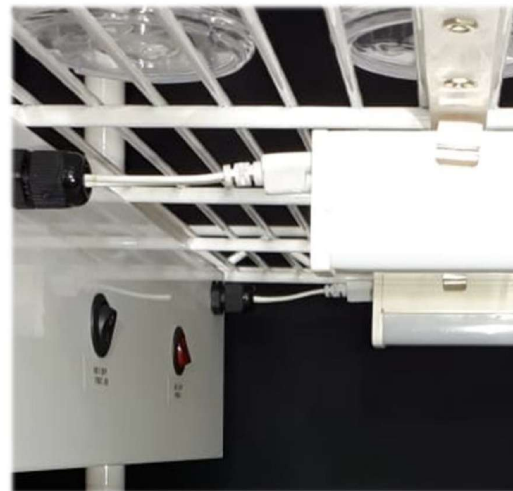
Iluminação fixadas por presilhas e conectadas por conector elétrico facilitando a substituição.
