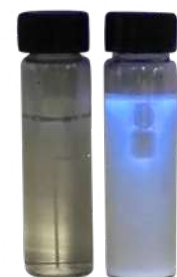
Caldo EC: Frasco esquerdo: Controle; Frasco direito: Caldo inoculado com Escherichia coli ATCC 25922
